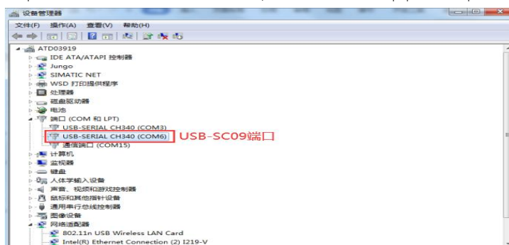
Figura 6.1 Visualización del número de puerto USB-SC09 en el Administrador de dispositivos
