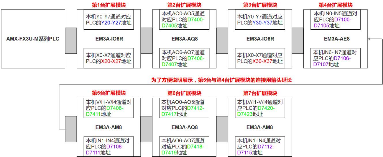
Figura 2.2 Caso de asignación de direcciones del módulo de extensión EM3A
