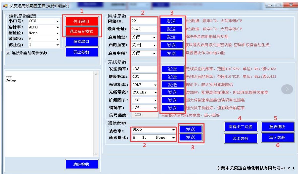
Figura 7.2.2 Configuración de parámetros del módulo
