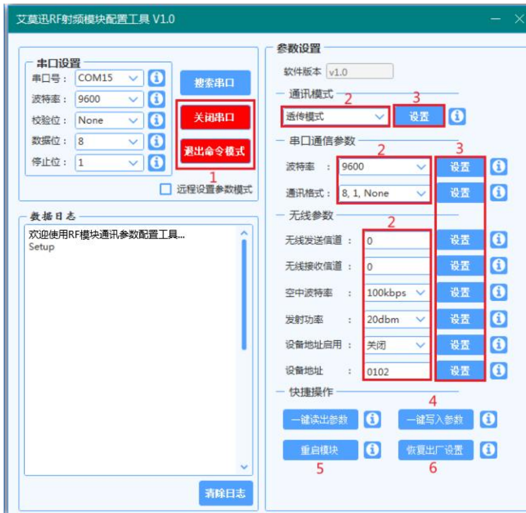
Figura 7.2.2 Configuración de parámetros del módulo
