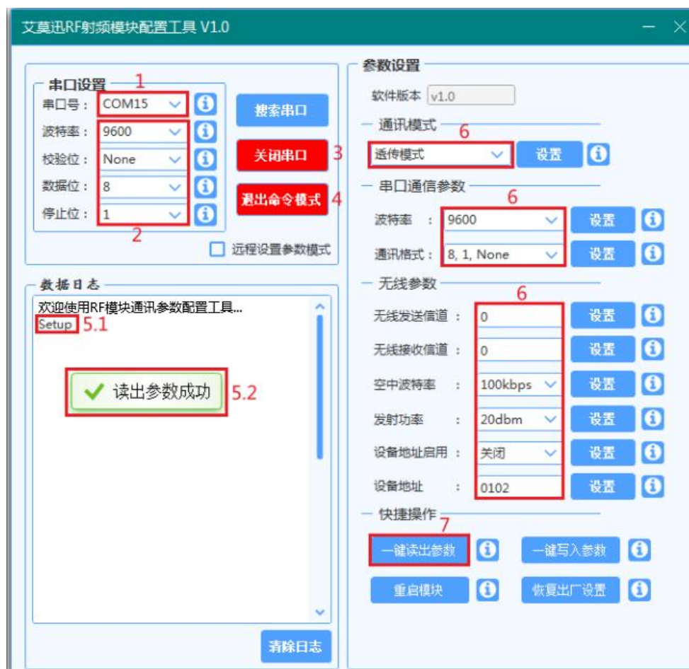
Figura 7.2.1 Conexión y lectura de parámetros del módulo de la herramienta de configuración
