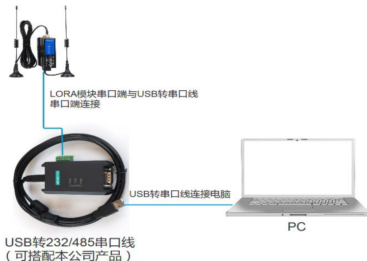
Figura 5.2 Diagrama de cableado para la configuración de parámetros del módulo LORA
