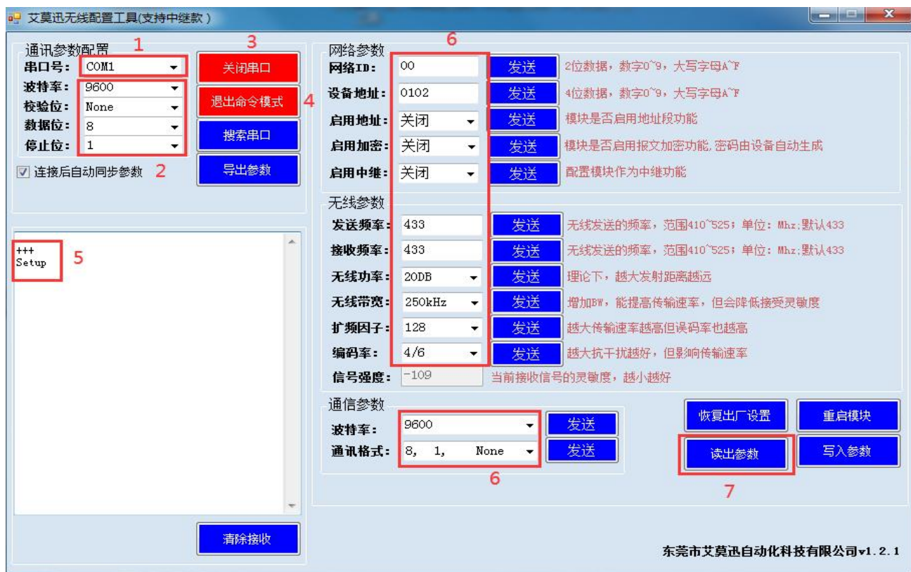
Figura 7.2.1 Conexión y lectura de herramientas de configuración
