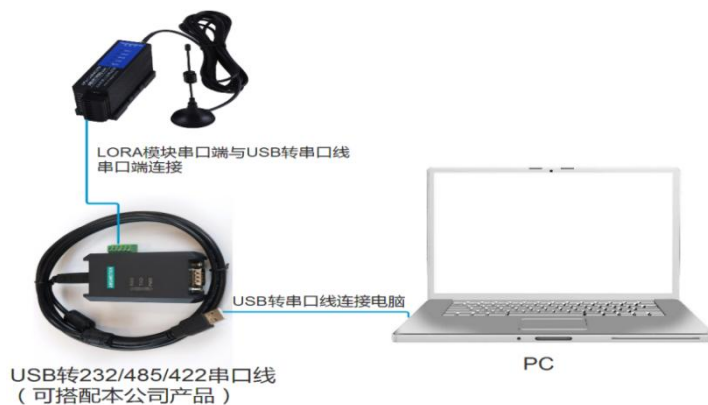
Figura 5.2 Diagrama de cableado para la configuración de parámetros del módulo LORA
