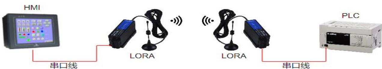
Figura 5.1.1.2 Comunicación punto a punto de un solo dispositivo
