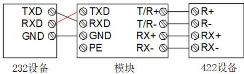
(1) Comunicación RS422 punto a punto/cuatro cables full-duplex
