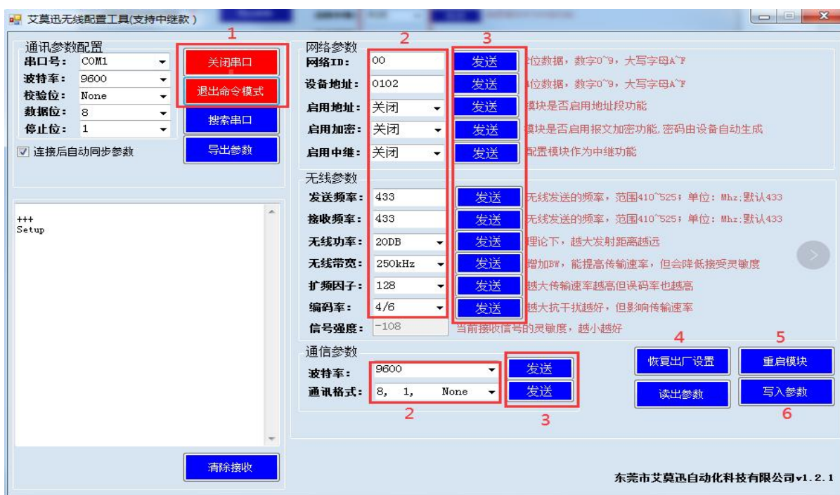
Figura 7.2.2 Configuración de parámetros del módulo
