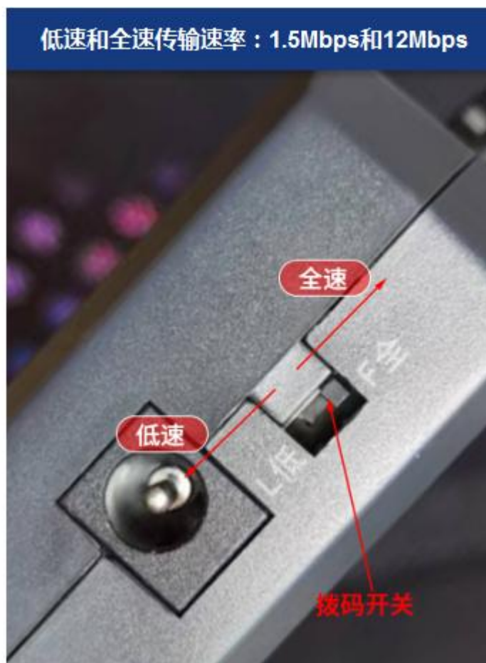
Figura 2. Diagrama esquemático de conmutación USB-USB-P/10W de baja velocidad/velocidad máxima.
