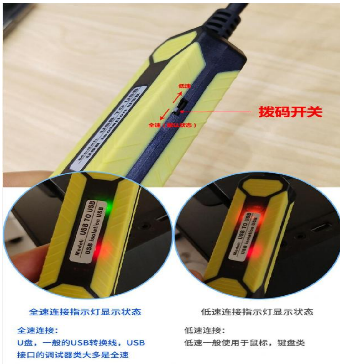
Figura 1. Diagrama esquemático de conmutación de USB a USB de baja velocidad/velocidad máxima.
