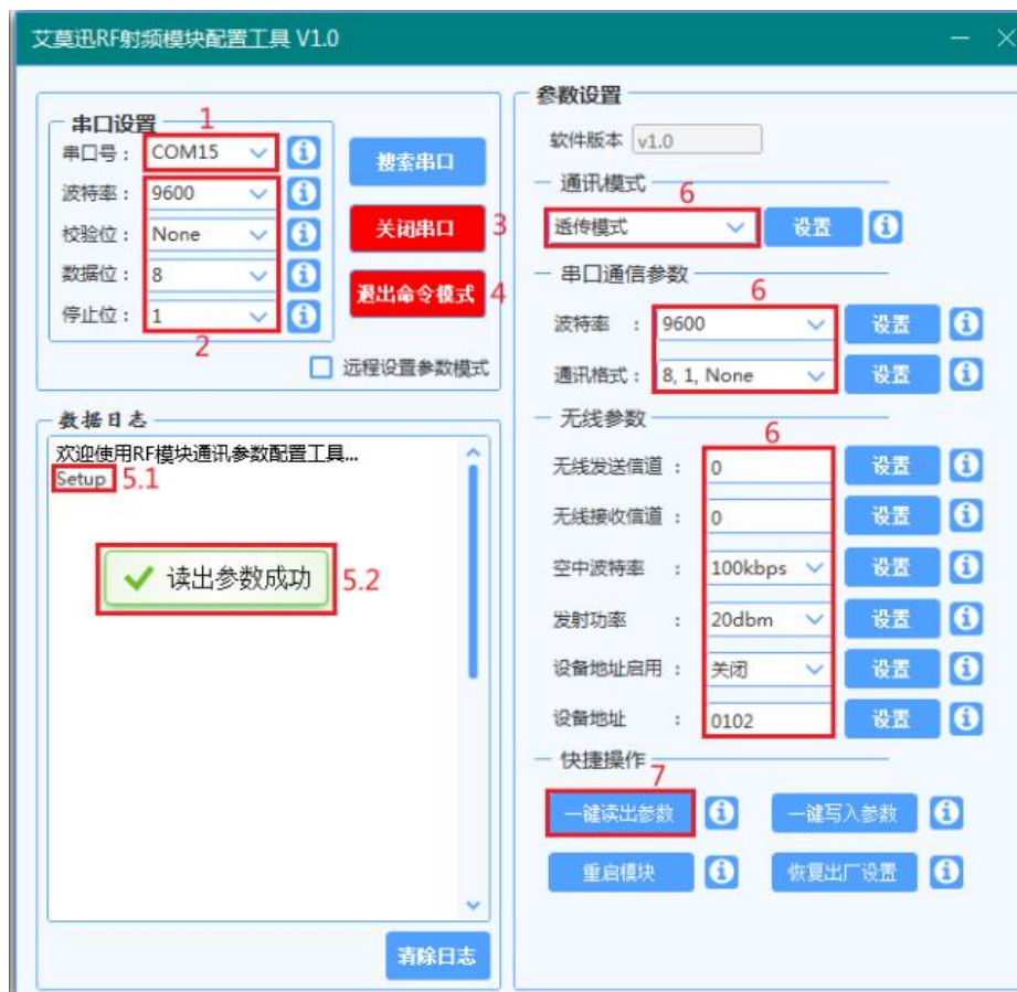
Figura 7.2.1 Conexión y lectura de parámetros del módulo de la herramienta de configuración
