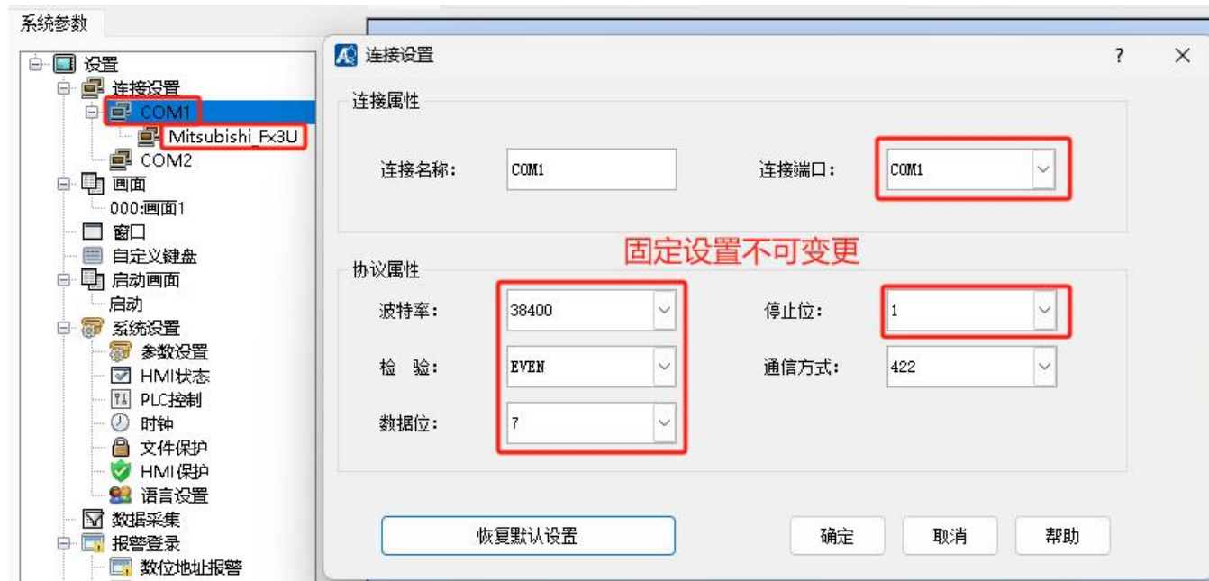
Figura 7.2 Configuración de conexión para la comunicación interna en HMISTUDIO
